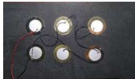
Gambar 7. Pengukuran Piezoelektrik Secara Seri
