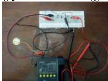
Gambar 3 Pengujian Piezoelektrik Menggunakan Ketukan
