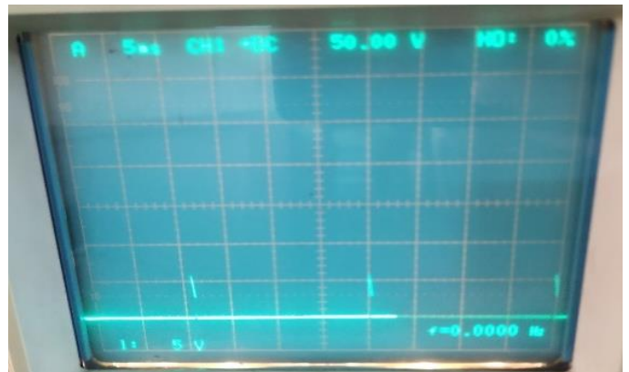
Gambar 9. Bentuk gelombang tegangan beban dari penyearah satu fasa terkendali setengah gelombang berbeban R = 10 \text{ k}\Omega dengan V_{dc} = 1,5 \text{ V} [ V_s = 220 \text{ V} , F_x = 5 \text{ ms/div} , F_y = 50 \text{ V/div} ]
