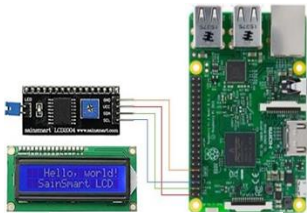
Gambar 9. Skema Tampilan Implementasi Raspberry Pi dengan LCD
